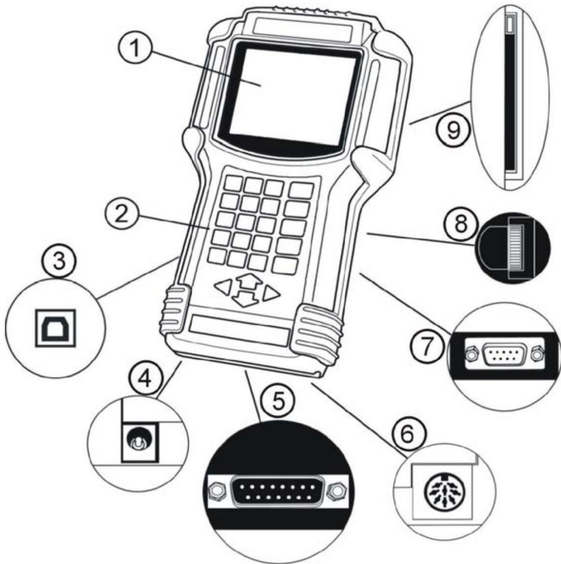
Рис. 7. Общий вид диагностического сканера Ultrascan P1 и его средства коммуникации:
